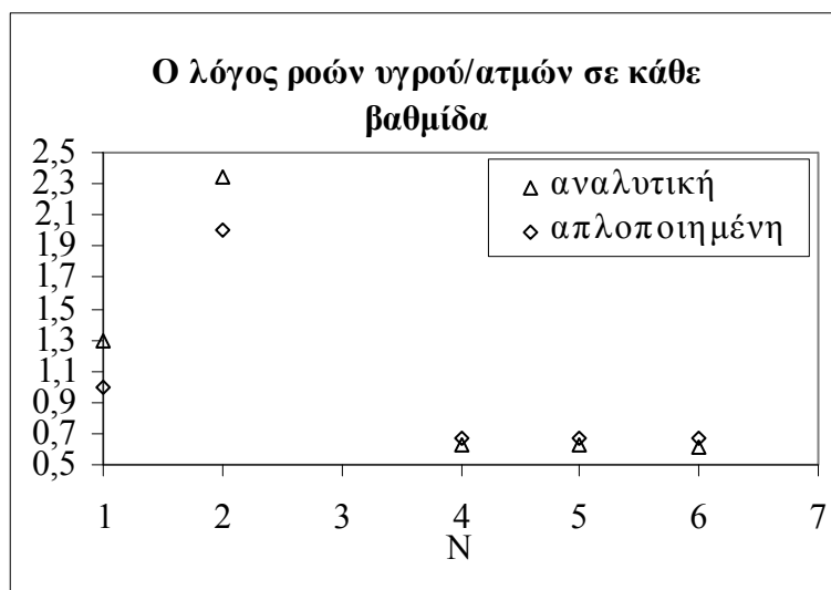
Σχήμα Π6-6 : Μεταβολή του λόγου γραμμομοριακής ροής υγρού προς γραμμομοριακή ροή ατμών εντός της στήλης για το παράδειγμα 3.
